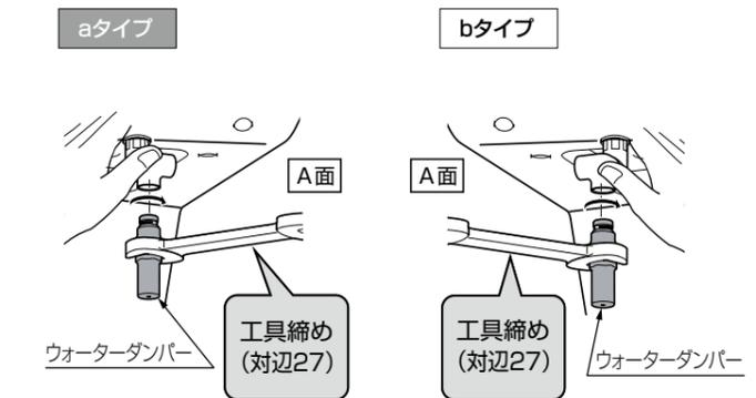
4. 減圧弁を手締めでいっぱいまでねじ込み、継手が真下にくるように戻す。
