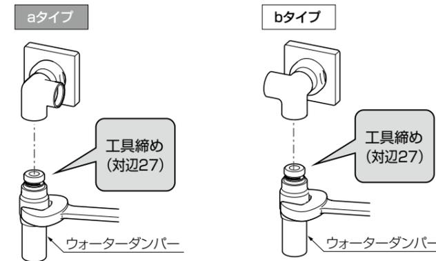
4. 減圧弁を手締めでいっぱいまでねじ込み、継手が真下にくるように戻す。
