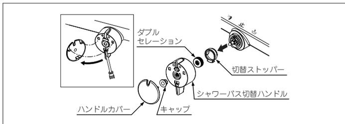
③モンキーレンチで固定ナットを緩めて外し、シャワーバス切替弁部を引き抜きます。
