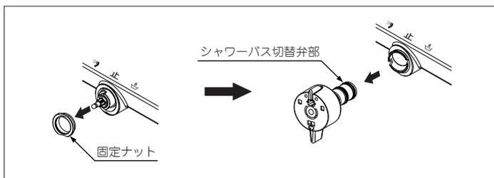
④新しいシャワーバス切替弁部をセットし、モンキーレンチで固定ナットを締め付け、切替ストッパー、ダブルセレクション、シャワーバス切替ハンドルを仮セットします。
