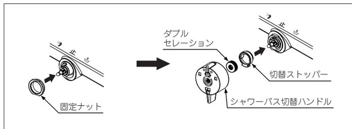
⑤流量調節栓を元の位置まで開け、シャワーバス切替ハンドルを操作し、動きがスムーズか、切替方向通りに湯水が出ているか、漏水などの不具合がないかなどを確認します。
