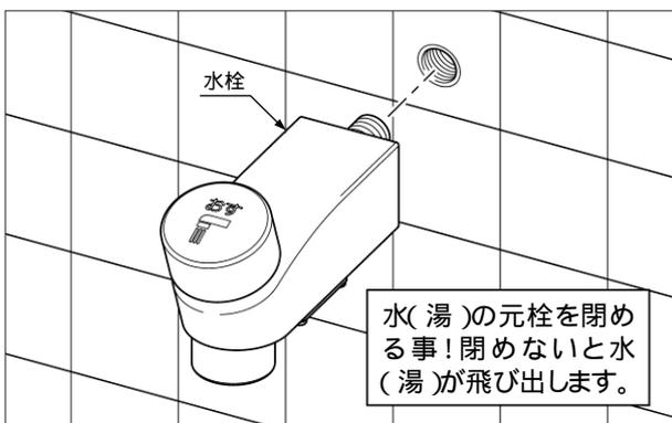
水栓を取り外さずに交換すると、誤った組み付けをする原因となり、漏水等機能不良の原因になります。
