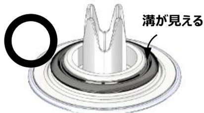
正しい状態 (溝が見える向きで取り付け)
