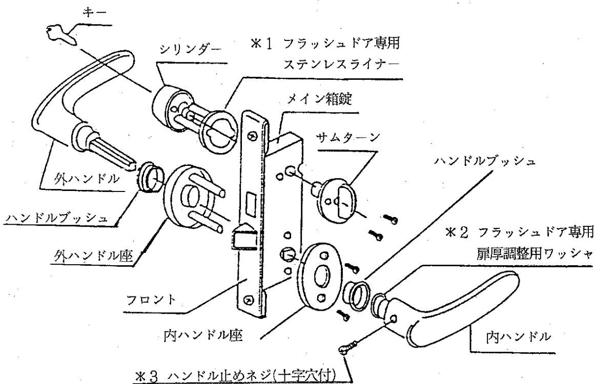
サブ箱錠の場合は、下図の部品を取付けて下さい
