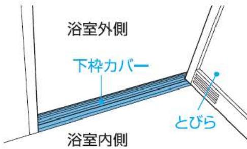
2 下枠カバーに指をかけて持ち上げ、取り外します。
