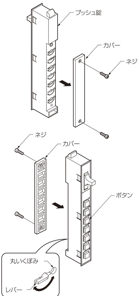
① 裏側についているネジを外してカバーを外します。
