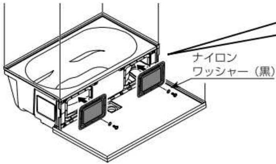
カウンターが工具に干渉する場合は、短小ドライバーで固定する。
