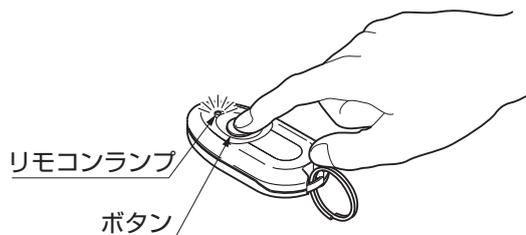
ボタン 3秒間 長押し → リモコンランプ 点灯 (電源ON)
