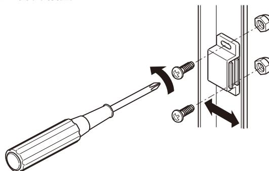
取付けねじは、袋ナットにて固定されていますので、ねじを回す際は袋ナットをスパナ等で押さえながら回してください。
