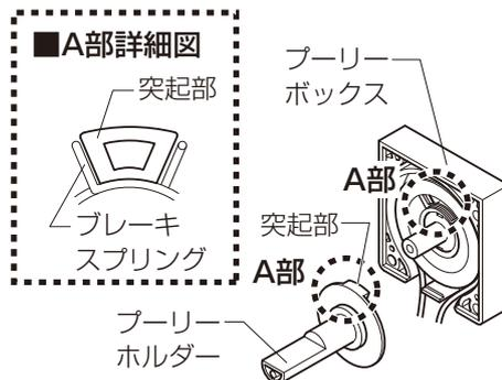
③ プーリーボックスとプーリーボックスカバーを図の向きで合わせて、ねじを締めて取付けます。
