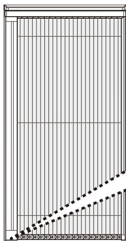
●網戸の開閉の際にスライドバー下部より異音(キーキー音)が発生する場合があります。その場合は、スライドバー下部のコーナーピース(左図)が汚れていると思われますので、網戸本体を取外し、ブラシなどで汚れを取除いてください。
