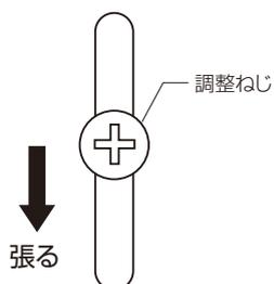
調整ねじを下方向に移動させてワイヤーの張り具合を調整します。
