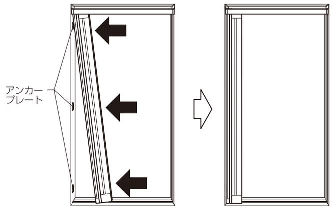
⑤網戸本体が全てのアンカープレートに固定されて、外れないか確認してください。
