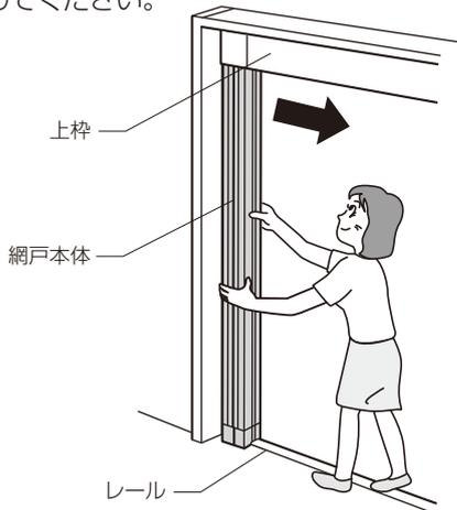
⑥網戸本体がアンカープレートに固定されて、すき間が無い確認したら、開閉確認をして完了です。
