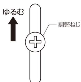
調整ねじを上方向に移動させてワイヤーの張り具合を調整します。
