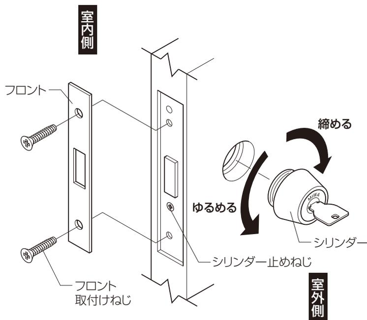
②シリンダー止めねじをプラスドライバーで締めてください。
