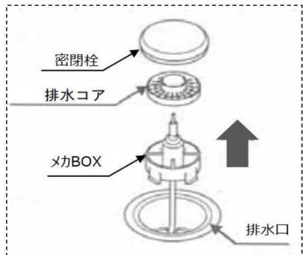
メカBOXを排水口から引き抜き、反時計周りにまわしてリリースから取り外します。
