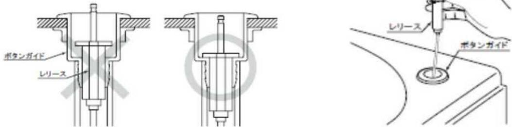
レリースを排水クロスに通し、排水口からレリース保護キャップを引き上げます。
