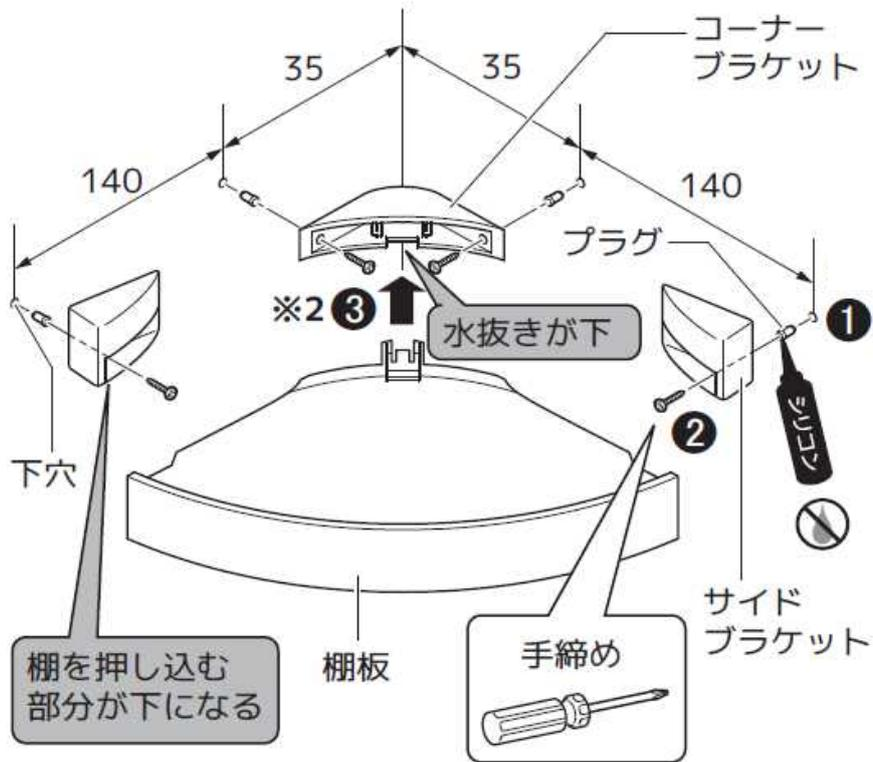
※2 棚板のサイドをサイドブラケットの溝へ合わせながら、棚板後部の凸部をコーナーブラケットの溝へゆっくりと、完全に固定されるまで押し込む
