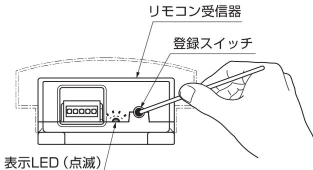
①リモコン受信器の登録スイッチをペン先やつまようじなどで押し、登録モードにします。表示LEDが点滅します。
