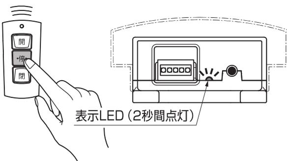
②登録するリモコン送信器の「停」ボタンを押します。表示LEDが2秒間点灯し、リモコン送信器の登録が完了します。
