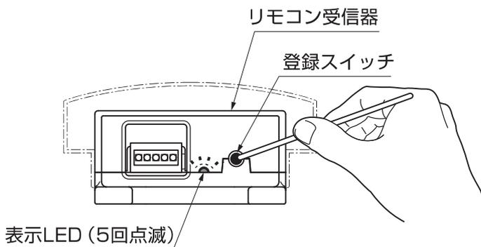
①登録スイッチを5秒以上長く押します。表示LEDが5回点滅します。
