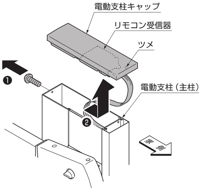
①電動支柱キャップを電動支柱（主柱）から取外してください。
