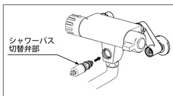
④シャワーバス切替弁部にダブルセレーション、シャワーバス切替ハンドルをはめ、ネジで固定します。
