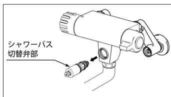
③新しいシャワーバス切替弁部（キャップ、ネジ、シャワーバス切替ハンドル、ダブルセレーションを外した状態）をモンキーレンチで右に回して水栓に固定します。
