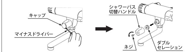
②-2. モンキーレンチでシャワーバス切替弁部を左に回してゆるめて外します。
