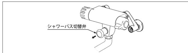
②-2. スパナ（対辺12）でシャワーバス切替ハンドル奥の四角面取部を左に回してゆるめシャワーバス切替弁部を外します。
