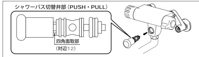
⑤流量調節栓を元の位置まで開け、開閉ハンドルを開けた状態でシャワーバス切替ハンドルを操作し、動きがスムーズか、切替方向通りに湯水
