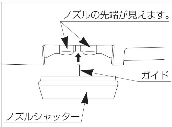
ノズルとノズルの間にシャッターのガイドを合わせて差し込みます。
