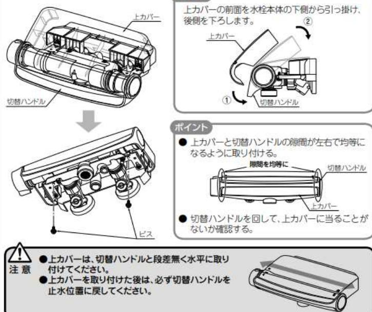
3. 下カバーを水栓本体に取り付け、ビス（2ヵ所）で固定する。
